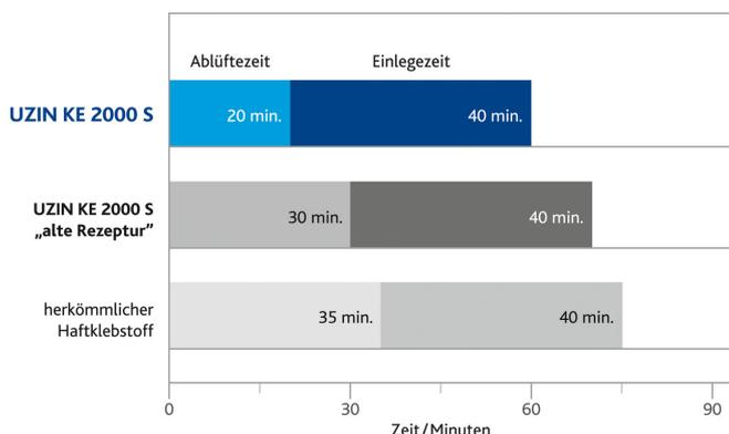
PVC-Bahnenverlegung auf UZIN NC 170 LevelStar, Zahnung A 2, bei 20 °C und 65 % relativer Luftfeuchte.
